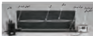
شکل ۳۶-۴ اسباب آزمایشی برای ایجاد موج ایستاده در تار کشیده. توجه کنید تری که به مولد نوسان متصل است، تقریباً در محل گره واقع است.
