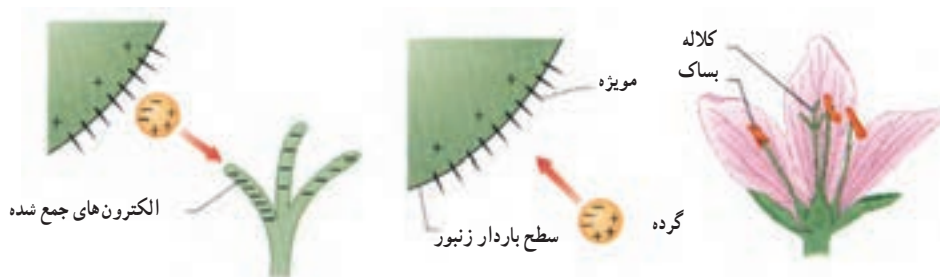
الف) اجزای بساک و کلاله یک گل ب) بر اثر حضور زنبور، روی گرده نزدیک بساک، بار القا شده است. پ) الکترون‌هایی که در نوک کلاله جمع شده اند، گرده را جذب می کنند.
